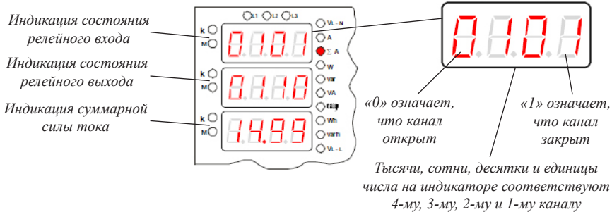
Рис. 15 – Пример работы прибора. Режим отображения суммарной силы тока. Суммарная сила тока равна 14,99 A
